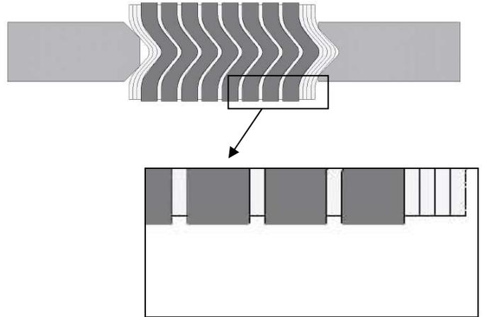
**FIGURE 8: FILLER PROTRUSION**
