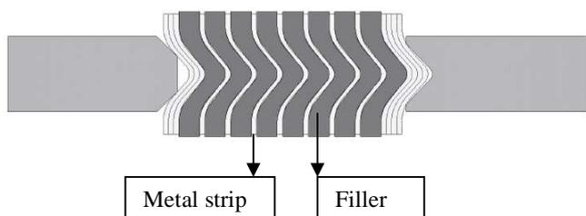
FIGURE 1: SPIRAL WOUND GASKET WINDING
